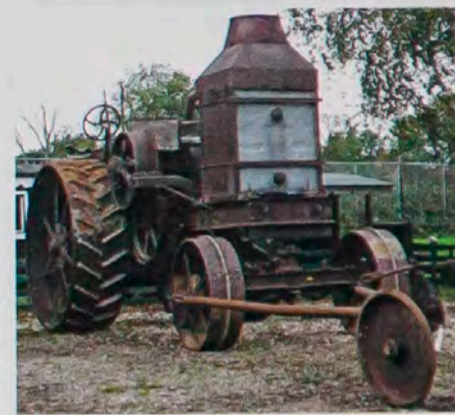
Cette pièce, constituée d'une longue tige au bout de laquelle on trouve une roue, se fixe sur le train avant et en suivant le premier sillon tracé, guide automatiquement le tracteur.
