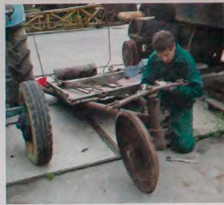
Cette pièce, constituée d'une longue tige au bout de laquelle on trouve une roue, se fixe sur le train avant et en suivant le premier sillon tracé, guide automatiquement le tracteur.
